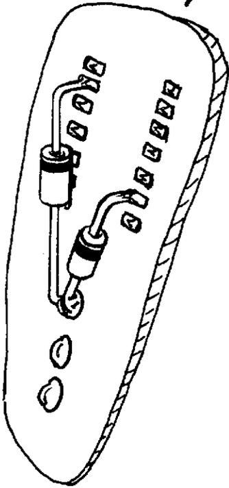
LEAVE 1/8" BETWEEN THE RESISTOR AND THE BOARD SO IT CAN "BREATHE".
